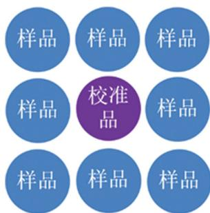
图 1 巴尔通体 MALDI-TOF MS 数据库建库靶板制备示意图
